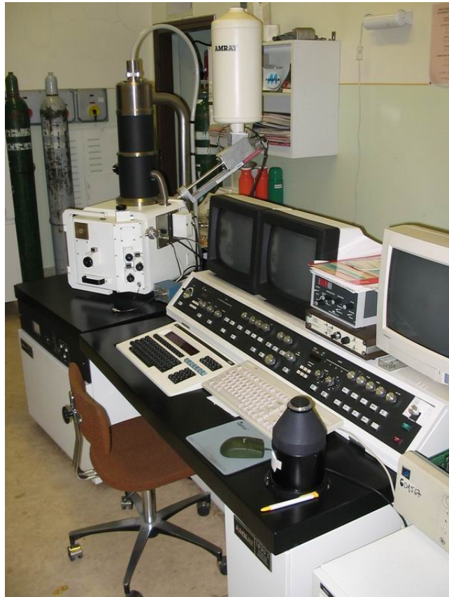
AMRAY 1830 I pásztázó elektronmikroszkóp
